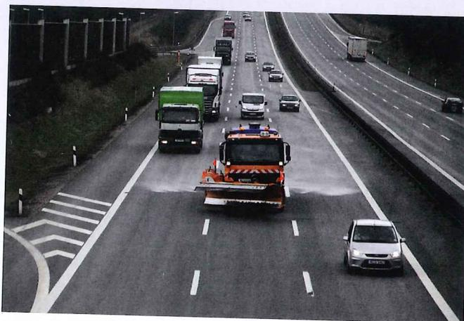
Bild 1: Der zunehmende Einsatz von Flüssigstreuung erhöht den Bedarf an Salzlösung (Quelle: Bayerische Straßenbauverwaltung)
