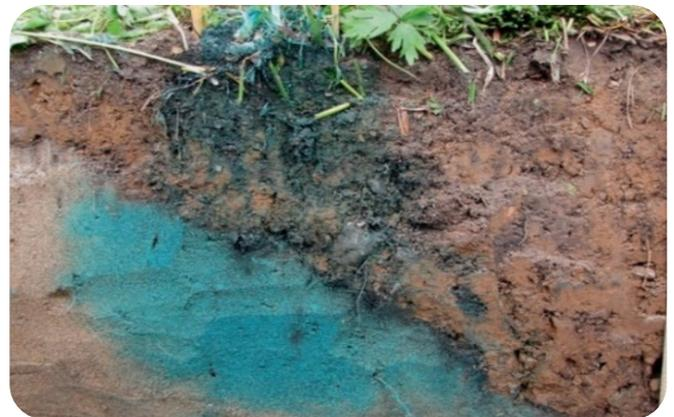
Strukturell bedingter Makroporenfluss im Boden, mit Farbtracer eingefärbt. ©Kulli
