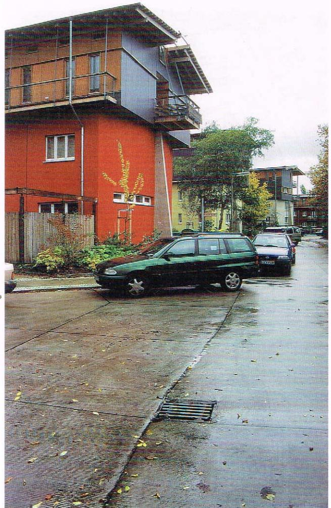
Bild 3: Lüdeckestraße mit Kopfbauten und Aufstockung der 1998 modernisierten Wohnhäuser. Dach- und Straßenflächen sind Einzugsgebiete des genutzten Regenwassers. Dies entspricht nicht den heutigen Regeln der Technik, ist jedoch als Sonderbauweise mit spezieller Aufbereitung bis heute in Betrieb. (Foto: Klaus W. König)
