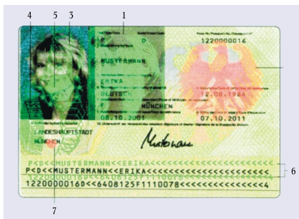
Abb. 6: Die neuen deutschen Ausweise und Reisepässe nutzen individualisierte Hologramme als fälschungssichere Sicherheitsmerkmale (1: Hologramm der Passinhaberin oder des Passinhabers, 2: Hologramm des dreidimensionalen Bundesadlers, 3–5: „kinetische“ Strukturen, 6 und 7: maschinenlesbare Schrift). Die einzelnen Hologramme erscheinen nur unter bestimmten Betrachtungswinkeln und nur in bestimmten Farben. (G. Dausmann, Holographic Systems München GmbH)
