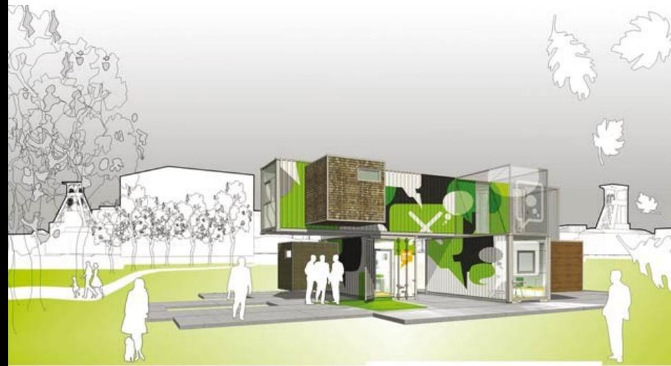
Raumzellen werden teilweise innerhalb von (Stahl-) Skeletten eingesetzt, z.B. für die Nasszellen, oder aber als ganze tragende Einheiten zu einem Gebäude zusammengesetzt (selten bei mehrgeschossigen Gebäuden).
