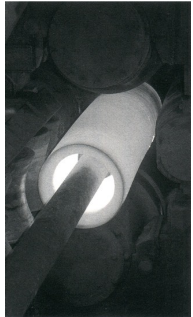
hohlprofil-000-1 Schrägwalzen eines Hohlblocks zur >Luppe<
