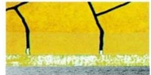
Der Synergie-Effekt verlängert die Schutzdauer der einzelnen Systeme. Der Verlängerungsfaktor liegt je nach System zwischen 1,2 und 1,5.
