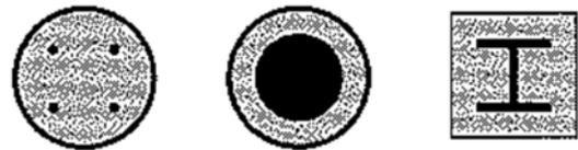
**Abb. 29: Stützen als Verbundtragwerk**
