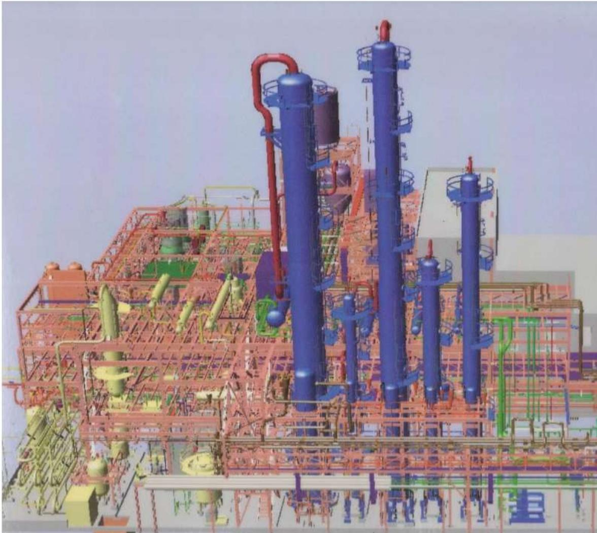
**Abb. 7.8** 3D-CAD-Anlagenmodell einer Chemieanlage (Praxisbeispiel)
