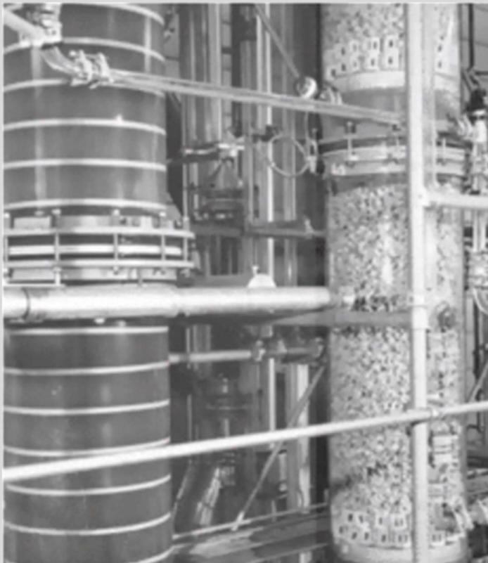
Extraktions- und Füllkörper-Rektifikationskolonne, © De Dietrich Process Systems GmbH.
