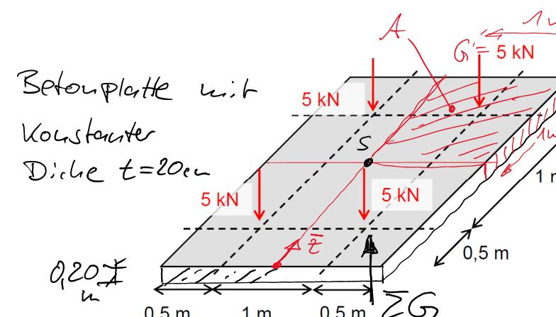
$$G = 0,2\text{m} \cdot 2,5 \frac{\text{KN}}{\text{m}^2} \cdot 1\text{m} \cdot 1\text{m} = 5\text{KN}$$
