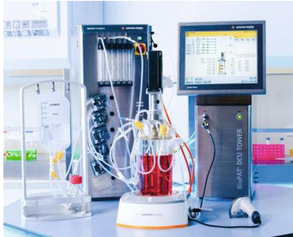
Abb. 1 (a): Der Univessel SU ist ein neuer Einweg-Rührbioreaktor, ... (Bild: Sartorius Stedim Biotech)
