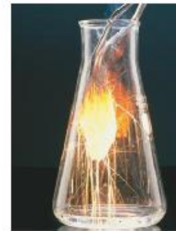
Erhitzte Stahlwolle, heftige Bildung von Fe_2O_3
