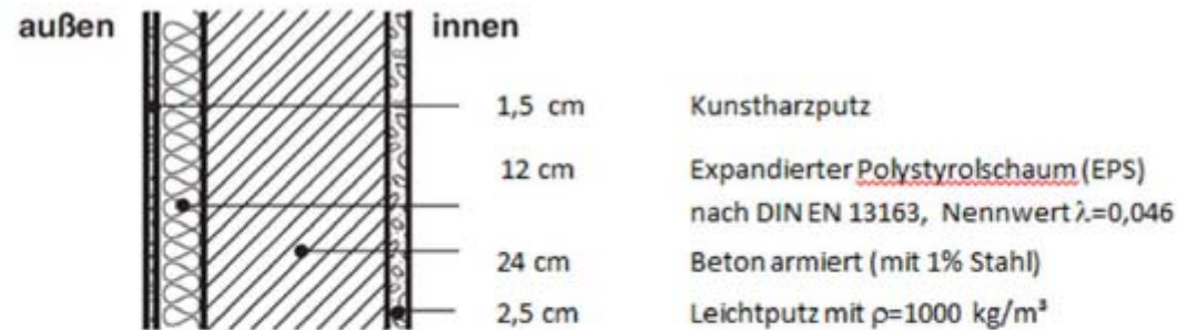
Bild 1: Skizze des Schichtenaufbaus der Außenwand
