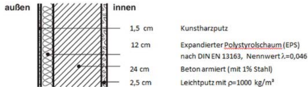
Bild 1: Skizze des Schichtenaufbaus der Außenwand
