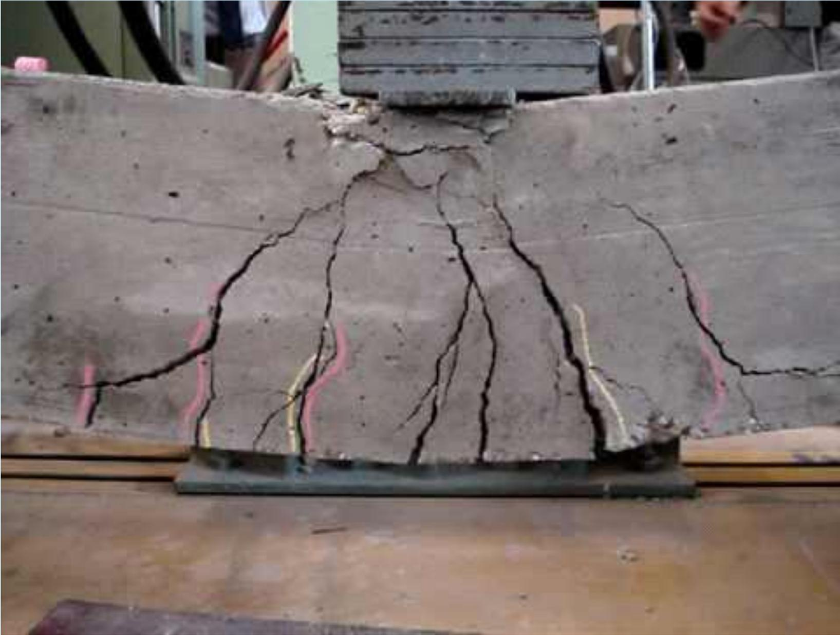
Stahlbeton-Unterzugdecke: **Unbewehrter Beton**
