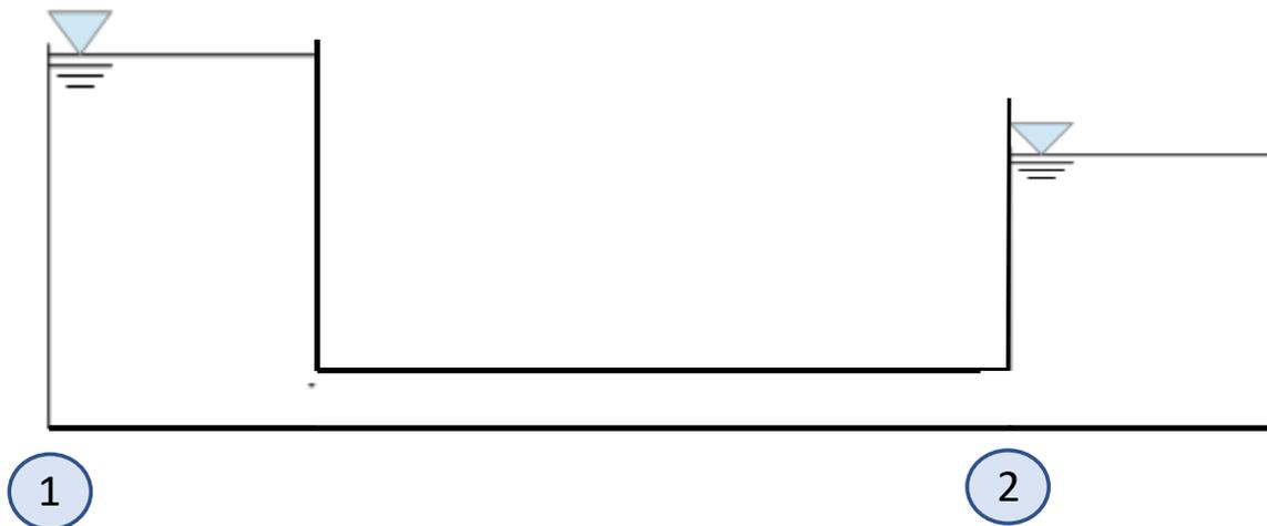
Zeichnen Sie den Energiehorizont, die Energielinie und die Drucklinie qualitativ in das dargestellte System aus Behältern und verbindende Rohrleitung mit Berücksichtigung von Verlusten ein!
