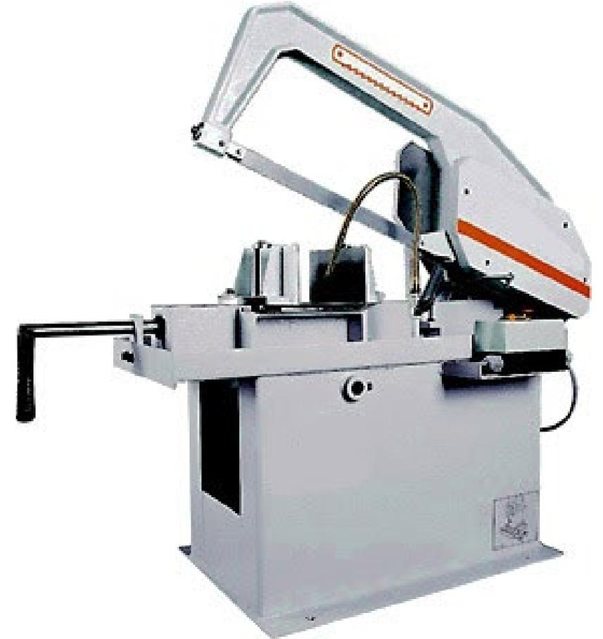
Eine weitere automatische Sägemaschine ist die **Bandsäge**. Sie ist eine geschlossene Maschine, in der ein bis zu 5 Meter langes Band mit Sägezähnen durchläuft. Deswegen entsteht kein Leerhub, sodass die Bandsäge deutlich produktiver arbeitet.
