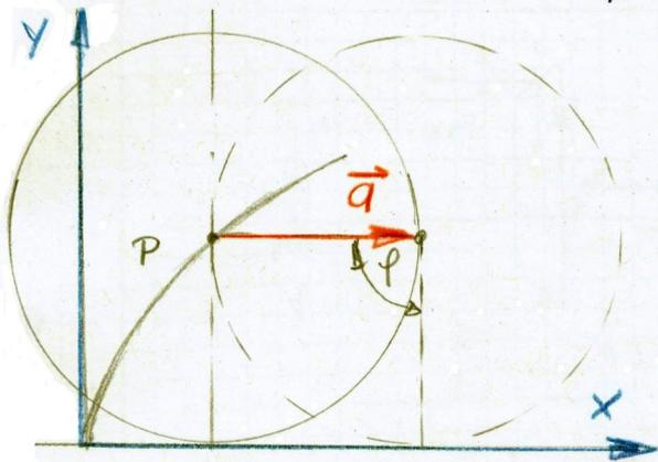
$$\vec{a} = 30 \frac{\text{mm}}{\text{s}^2} \begin{bmatrix} 1 \\ 0 \end{bmatrix}$$
