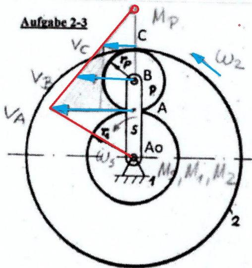
In dem skizzierten Planetengetriebe hat das Sonnenrad 1 den Teilkreisradius  $r_1$ , das Planetenrad P hat den Teilkreisradius  $r_p$ , und der Steg s zwischen den Mittelpunkten dieser beiden Räder dementsprechend die Länge  $(r_1 + r_p)$ . Die Innenverzahnung 2 am Gehäuse hat den Teilkreisradius  $(r_1 + 2 r_p)$ .
