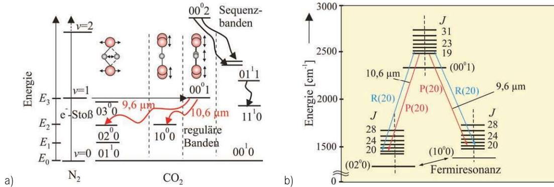
**Bild 3.2** Energieniveauschema des CO<sub>2</sub>-Lasers. a) Termschema /Eich2010/, b) Darstellung der Laserübergänge /Kneu2008/
