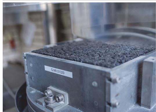
Nach ca. 15 Minuten muss der abgekühlte, aber noch warme Gussasphalt mit einer heißen planebenen Platte an der Oberfläche geglättet werden. Ist der Asphalt auf Raumtemperatur abgekühlt, kann er aus der Form genommen und den weiteren Untersuchungen unterzogen werden.
