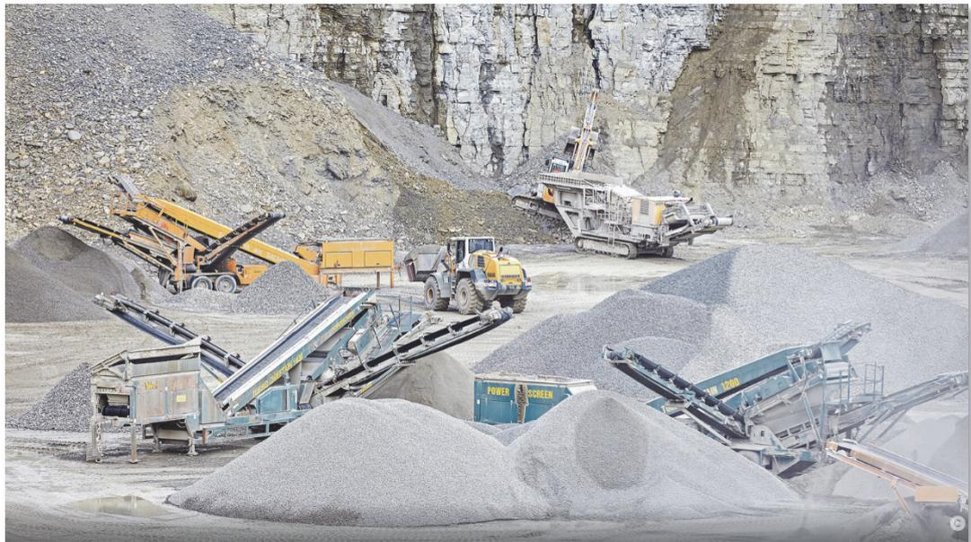
Damit Gesteinskörnung und Bitumen ein möglichst tragfähiges Gerüst ergeben, müssen die verwendeten Gesteine aus **gebrochenem** Korn und einer Mischung aus groben (Korngröße von 2 bis 45 mm) und feinen Gesteinskörnungen (Korngröße kleiner als 2 mm) bestehen.
