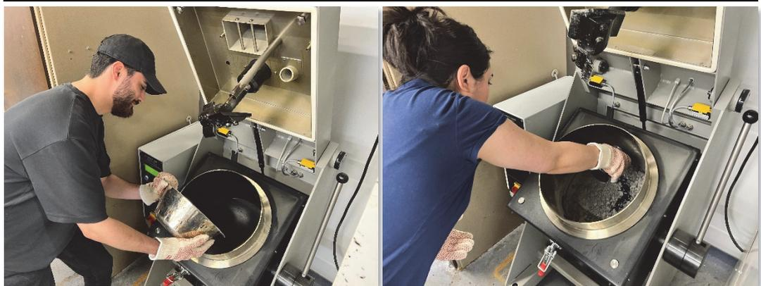
Im Rahmen von **Kontrollprüfungen** ist ein Zusammensetzen des Asphaltes im Labor nicht erforderlich, da die Probenahme des fertig gemischten Asphaltes auf der Baustelle erfolgt. Dabei wird der aus dem Mischwerk angelieferte Asphalt direkt am Straßenfertiger entnommen, in Eimer gefüllt und in die Prüfstelle transportiert. Nach Einbau des Asphaltes werden weitere Proben direkt aus der Asphaltbefestigung - im Regelfall in Form von Bohrkernen - entnommen.
