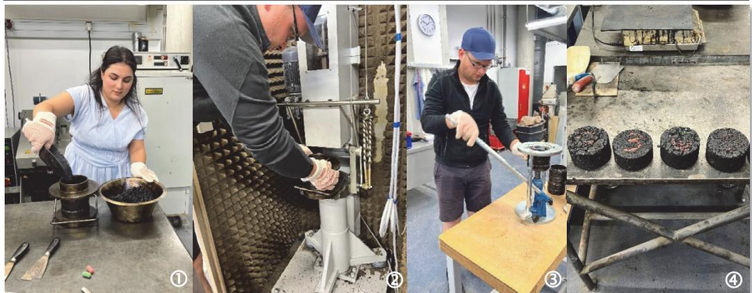
*Bild C20: Funktionsprinzip des Marshall-Verdichtungsgerätes [bearbeitete Quelle: PCTE]*
