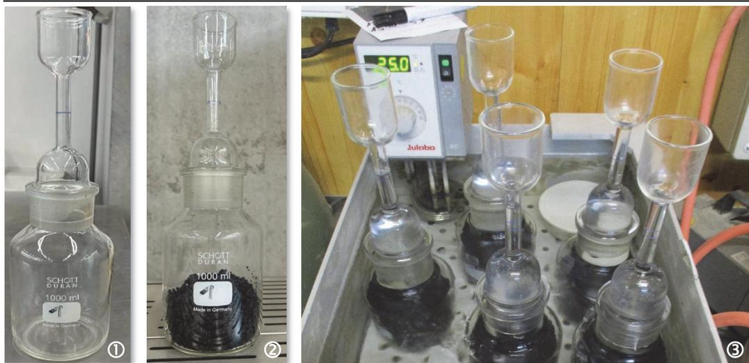
Nach der Lagerung wird das Pyknometer bis zur Füllmarke mit Wasser aufgefüllt und erneut gewogen (Gewicht  $m_3$ ). Durch die Kalibrierung ist das Volumen bis zur Füllmarke bekannt, so dass die Berechnung der Asphaltrohddichte wie folgend erfolgen kann:
