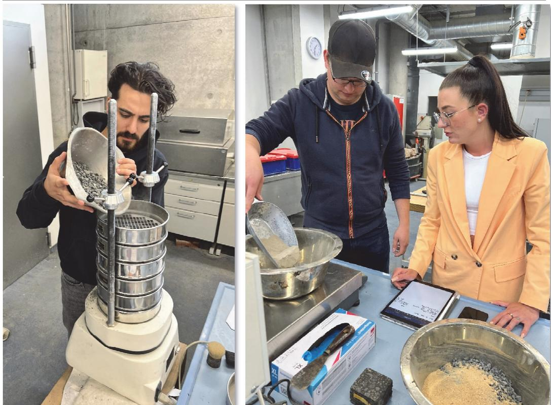
Für eine **Erstprüfung** wird das geeignete Gesteinskörnungsgemisch für den vorgesehenen Asphalt erstmals zusammengesetzt. Hierfür werden die einzelnen Lieferkörnungen (z.B. 0/2, 2/5, 5/8 etc.) per Siebung analysiert und danach zu einem Gesteinskörnungsgemisch zusammengesetzt.
