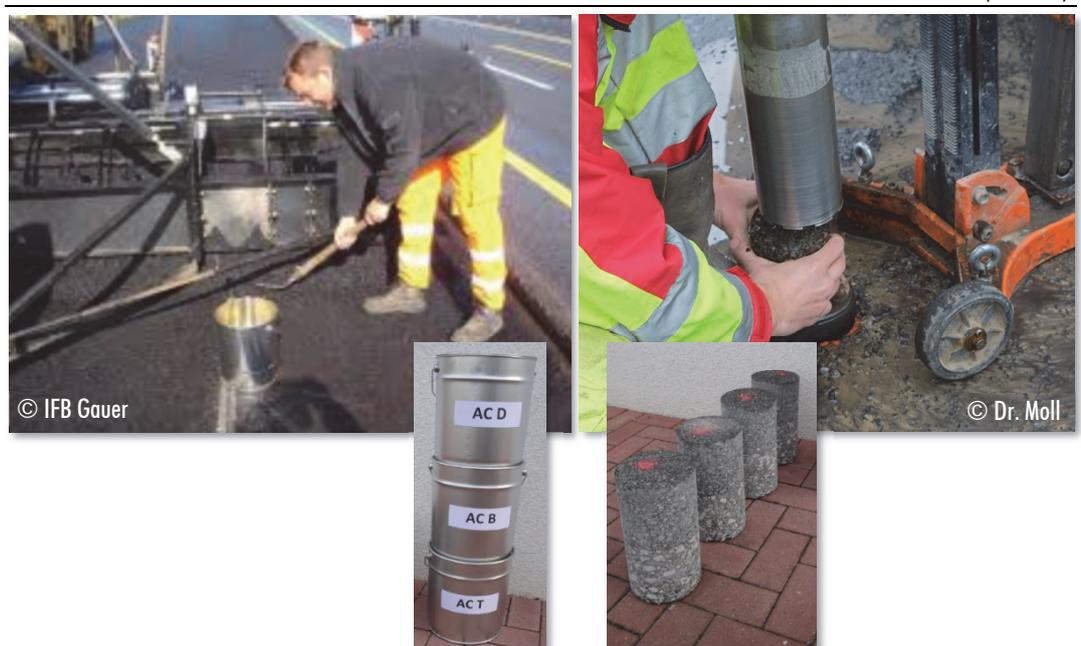
Im Gegensatz zur Erstprüfung, mit der die Rezeptur des Asphaltes bestimmt wird, klärt die Kontrollprüfung, ob die Vorgaben aus der Erstprüfung in der Asphaltmischanlage tatsächlich eingehalten wurden und ob der Asphalt richtliniengemäß eingebaut wurde.
